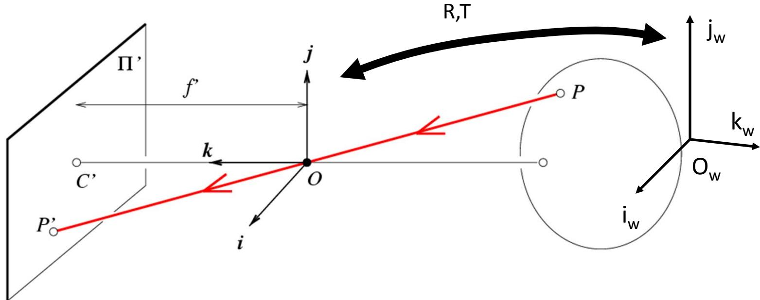
$$P'_{3 \times 1} = M \quad P_w = K_{3 \times 3} [R \quad T]_{3 \times 4} \quad P_{w4 \times 1}$$
